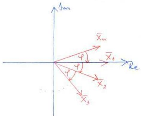
$$\begin{aligned} \bar{X}_1 &= X_m \cdot \cos(\omega t) \longrightarrow \bar{X}_1 = X_m \\ \bar{X}_2 &= X_m \cdot \cos(\omega t - \varphi) \longrightarrow \bar{X}_2 = X_m e^{-j\varphi} = \bar{X}_1 e^{-j\varphi} \\ &\vdots \\ \bar{X}_n &= X_m \cdot \cos(\omega t - (n-1)\varphi) \longrightarrow \bar{X}_n = X_m e^{-j(n-1)\varphi} \end{aligned}$$
