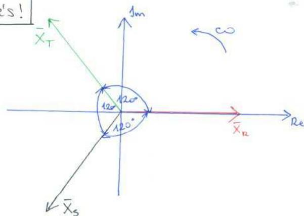
$\bar{X}_R, \bar{X}_S, \bar{X}_T$  pozitív-sodrású rendszert alkot.
